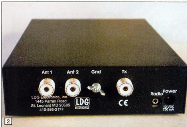
voir son champ d'application s'étendre aux lignes parallèles ou longs-fils si on le munit d'un balun optionnel. En option, une interface est disponible pour les transceivers des 4 grands fabricants : Alinco, Icom, Kenwood, Yaesu. Alimenté sous 12 V (11 à 15 V), le coupleur consomme 750 mA pendant la phase de réglage puis se met en sommeil et ne requiert alors qu'une dizaine de milliampères.
