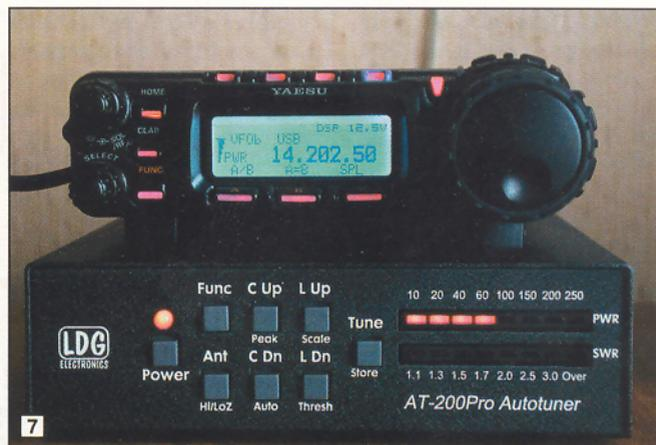
étudié ! Pour corser les essais, nous avons raccordé l'AT-200PRO à notre centerfed (à travers un transformateur 4:1) et, là encore, à deux exceptions près (que nous avons rattrapées manuellement, d'où l'intérêt d'avoir accès à ces réglages !), nous avons pu utiliser l'antenne en émission même dans les cas les plus improbables ! Pendant les temps de recherche, les relais sont mis à contribution, générant un bruit assez important mais, soyons honnête, de courte durée.
